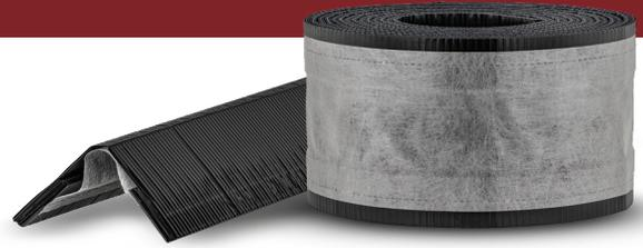
La cantidad de ventilación se controla mediante la longitud de la ranura cortada a lo largo de la cumbrera del techo. Para obtener la línea de techo más atractiva, se recomienda instalar los respiraderos de sección StormStop Ridge Vent Roll<sup>®</sup> o StormStop de CraftGrade a lo largo de toda la cresta del techo.
