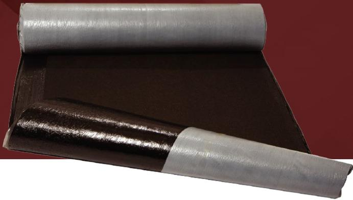
TopShield<sup>®</sup> Ice and Water G300 es una capa base bituminosa modificada autoadhesiva y reforzada con fibra de vidrio para techos para usar debajo de tejas de pizarra y tejas de asfalto. Los gránulos minerales en la superficie superior proporcionan propiedades antideslizantes.
